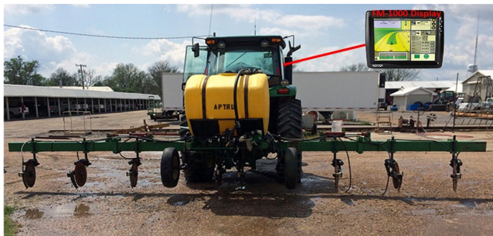
Рис. 1 - Система керування виливом Field-IQ, встановлена на засобі для внесення рідких добрив, та дисплей FM-1000 в кабіні
