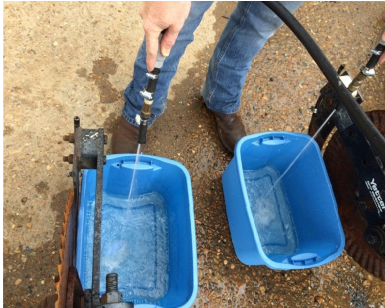
Рис. 2 – Збір витoku з виливної трубки для визначення швидкості потоку
