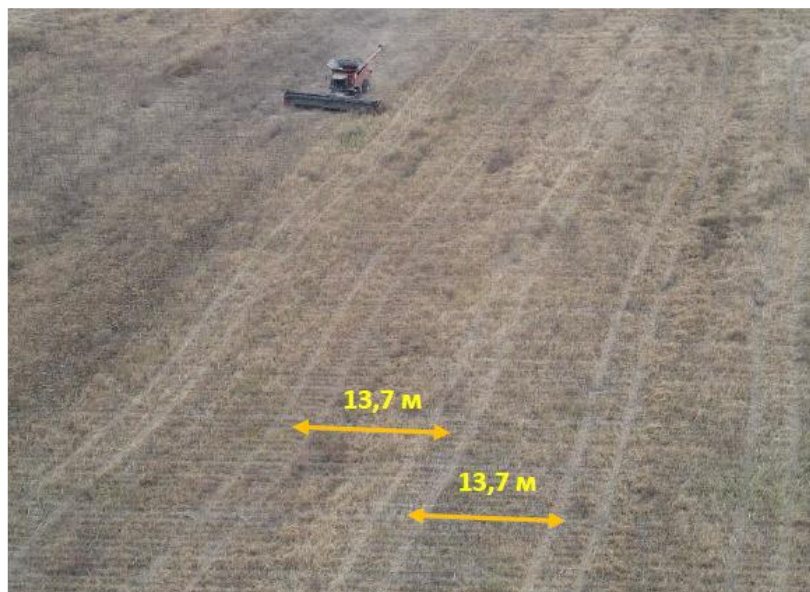
Рисунок 3.4- Комбайн Case IH 9240 на експериментальному полі з шириною між суміжними проходами – 13,7 м
