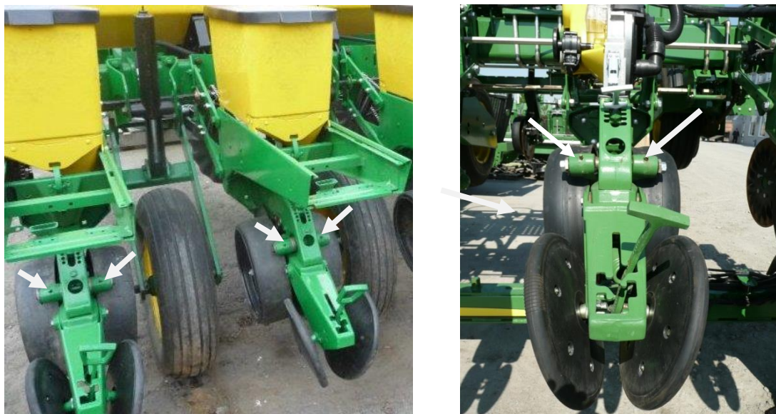
Рис. 1.8. Посівні секції сівалок виробництва John Deere з позначеними точками обслуговування
