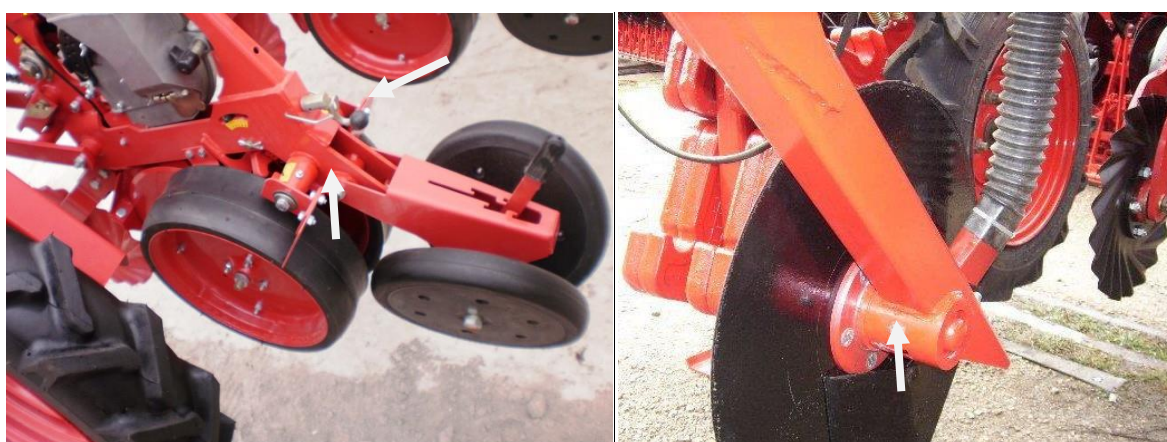
Рис. 1.10. Посівна секція сівалки VEGA PROFI (ПАТ «Ельворті») з позначеними точками обслуговування
