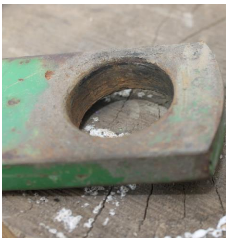
Рис. 1.6. Корозійна маса та надмірний знос важеля паралелограмного механізму копіювання рельєфу посівного комплексу John Deere 1710 (наробіток 1500 га)
