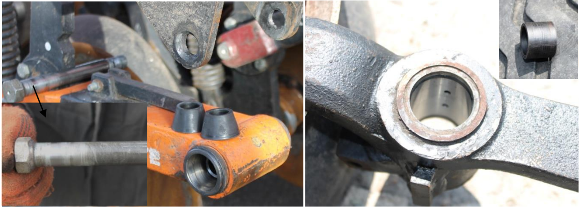
Рис. 3.5. Елементи рухомих з'єднань розробленої системи копіювання посівного комплексу Агро-Союз Turbosem II 19-60 (напрацювання 9179,5 га) а – деталі нижнього паралелограма; б – деталі шарніра опорного колеса
