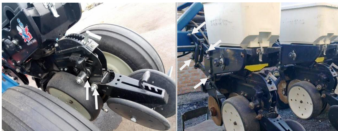
Рис. 1.9. Посівна секція сівалки KINZE 3600 з позначеними точками обслуговування
