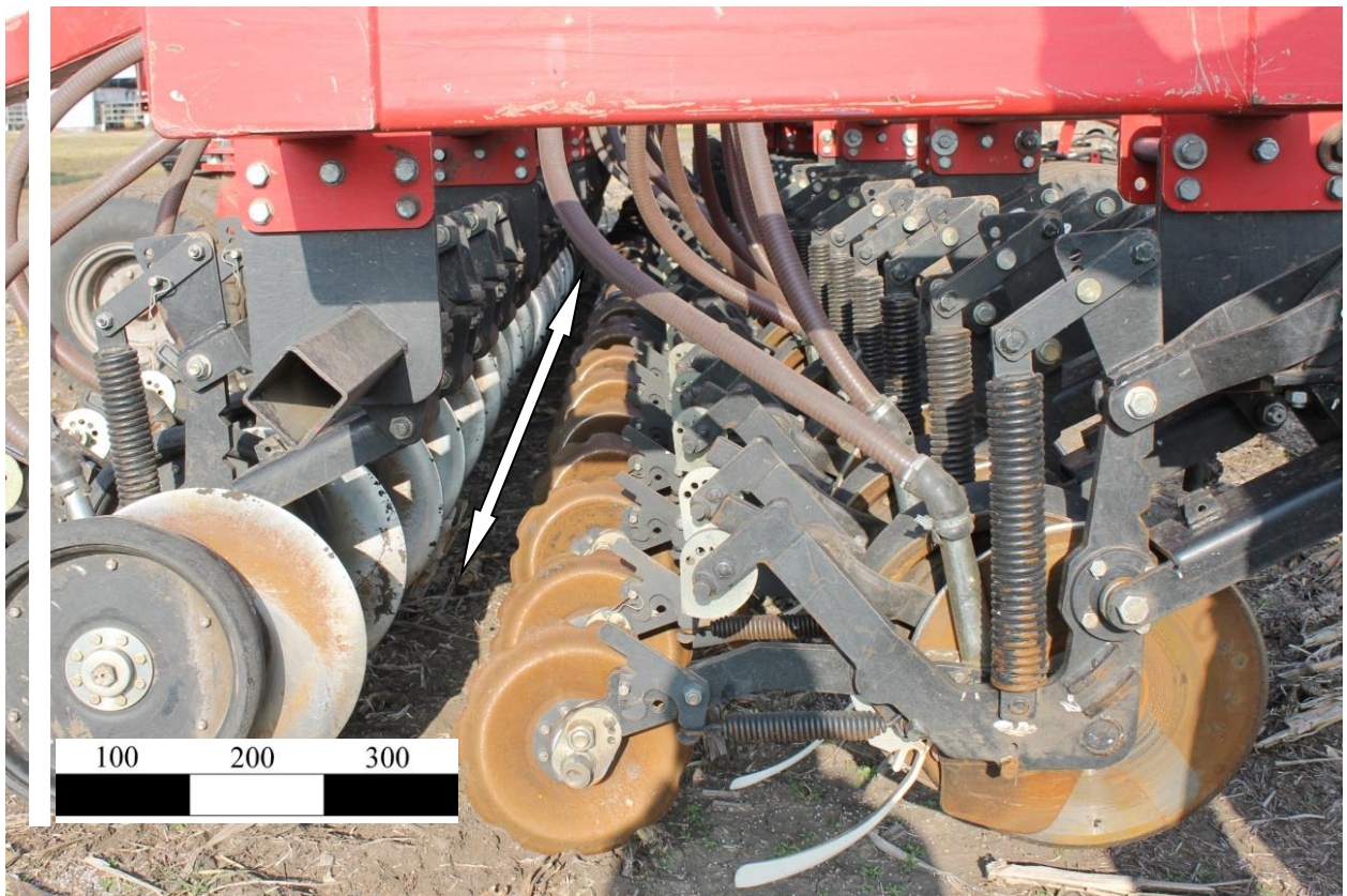
Рис. 1.15. Розміщення посівних секцій на рамі комплексу Агро-Союз Turbosem II 19-60 (стрілкою вказано простір для проведення технічного обслуговування рухомих з'єднань переднього ряду сошників).
