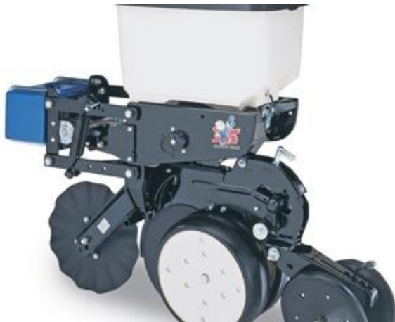
Рис. 1.12. Секції посівних комплексів з паралелограмними механізмами копіювання
