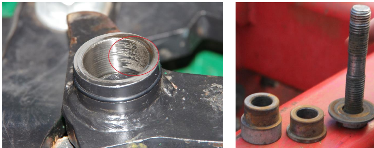
Рис. 1.5. Надмірний знос металевих деталей рухомих з'єднань паралелограмного механізму копіювання рельєфу посівного комплексу Агро-Союз Turbosem II 19-60 (48) після 1492 га наробітку
