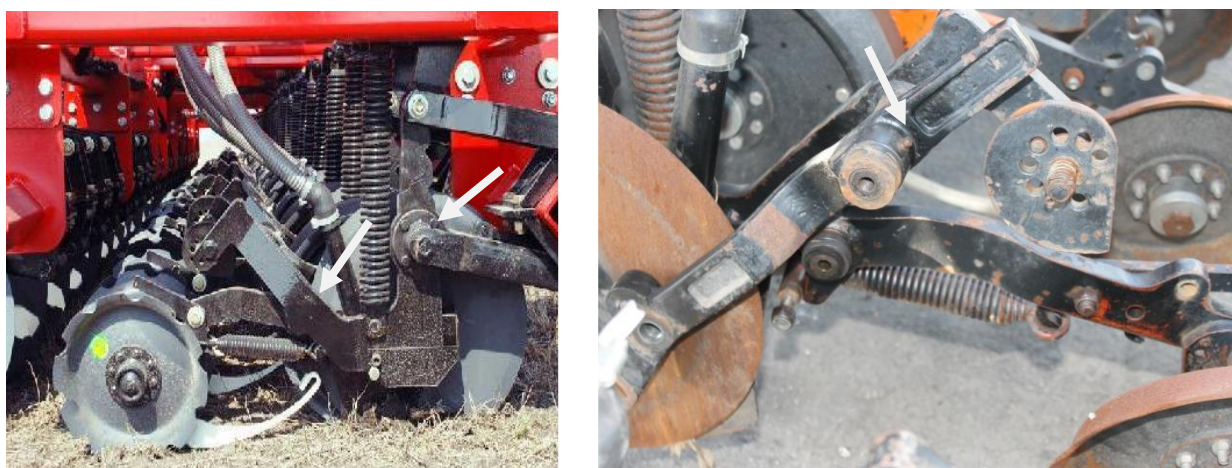
Рис. 1.11. Секції посівного комплексу Агро-Союз Turbosem II 19-60 з позначеними точками обслуговування
