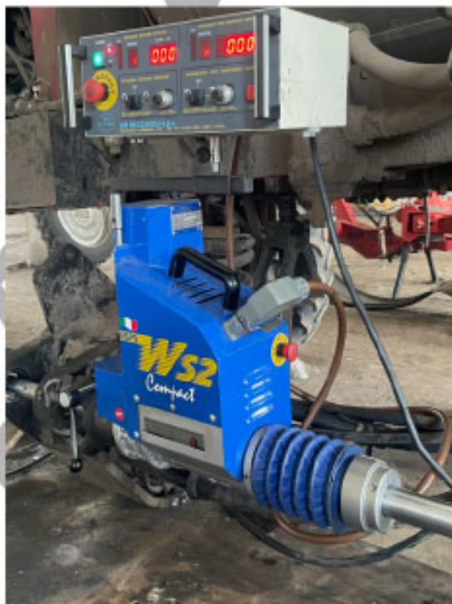
Рисунок 2.11 – Використання верстату WS2 при ремонтних роботах
