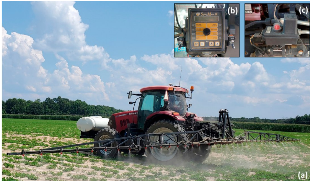
Рис. 1 - (а) Обприскувач зі складною штангою Demco X-fold, який використовувався для тестування ефективності розпилення. (b) Контролер норми Micro-Trak MT-2445F і (c) регулятор TeeJet 335BPR-2F-04
