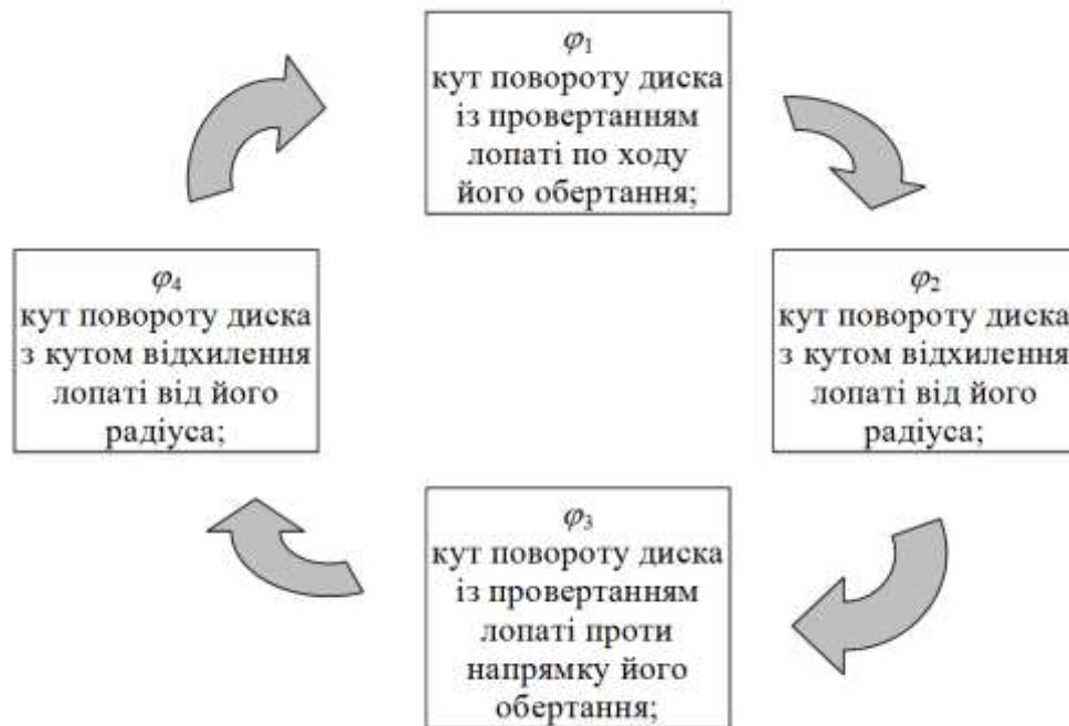
Рис. 2.4. Фази повороту диска розкидача
