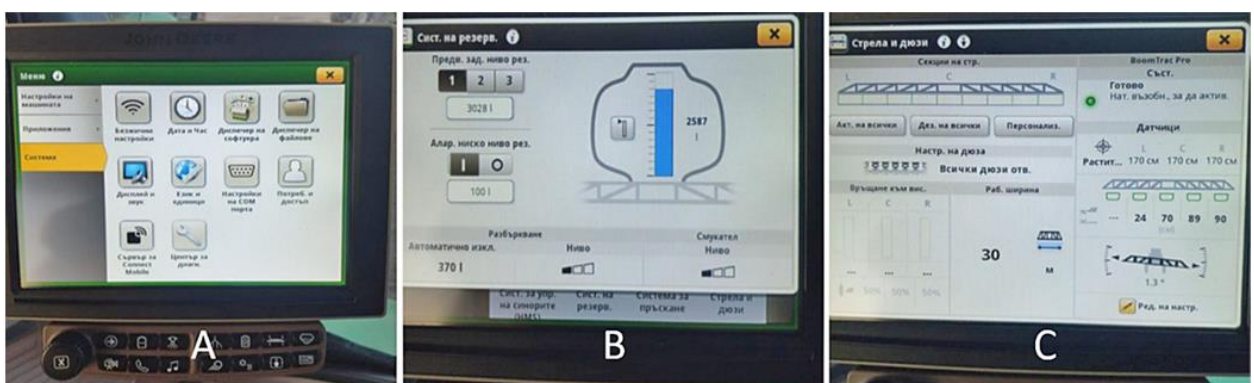
Рис. 3 – Налаштування параметрів агрегату А – Дисплей налаштувань машини, В – Дисплей для зчитування кількості пестициду в баку, С – Регулювання висоти гідравлічної штанги
