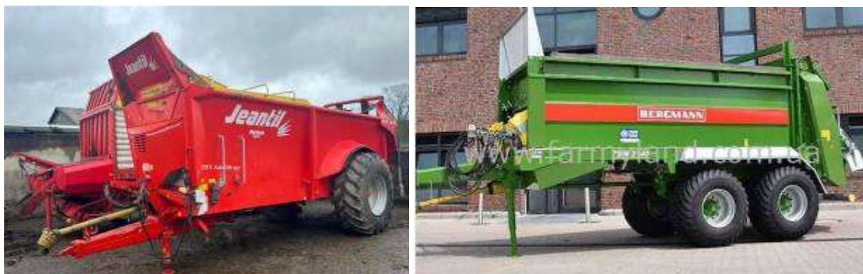
Рис. 3.9. Розкидачі органічних добрив з барабанно-шнековими розкидальними органами
