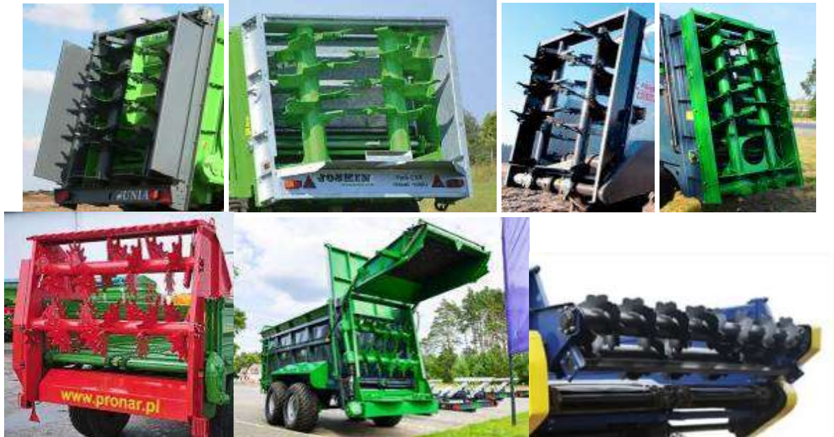
Рис. 1.6. Розкидальні механізми машин для внесення органічних добрив
