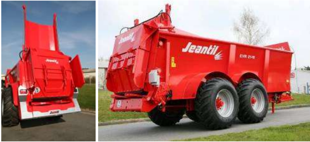
Рис. 3.10. Розкидачі органічних добрив з дисковим розкидальним робочим органом (Jeantil EVR 12-8 FIRST EPAN 5)
