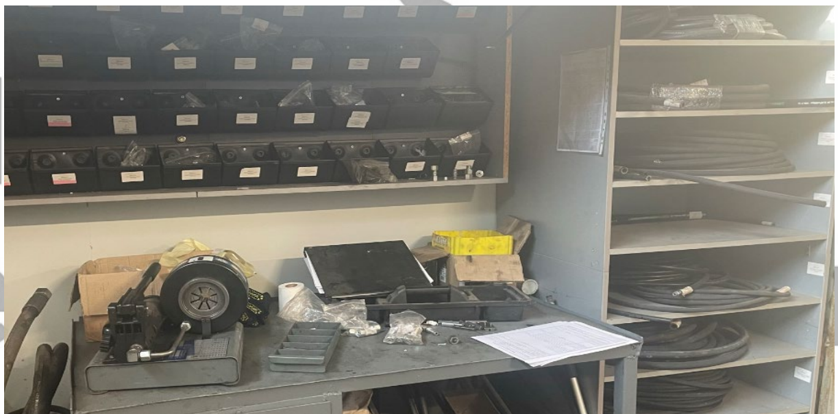
Рисунок 2.13 – Обладнання та інструменти для опресовування гідравлічних рукавів
