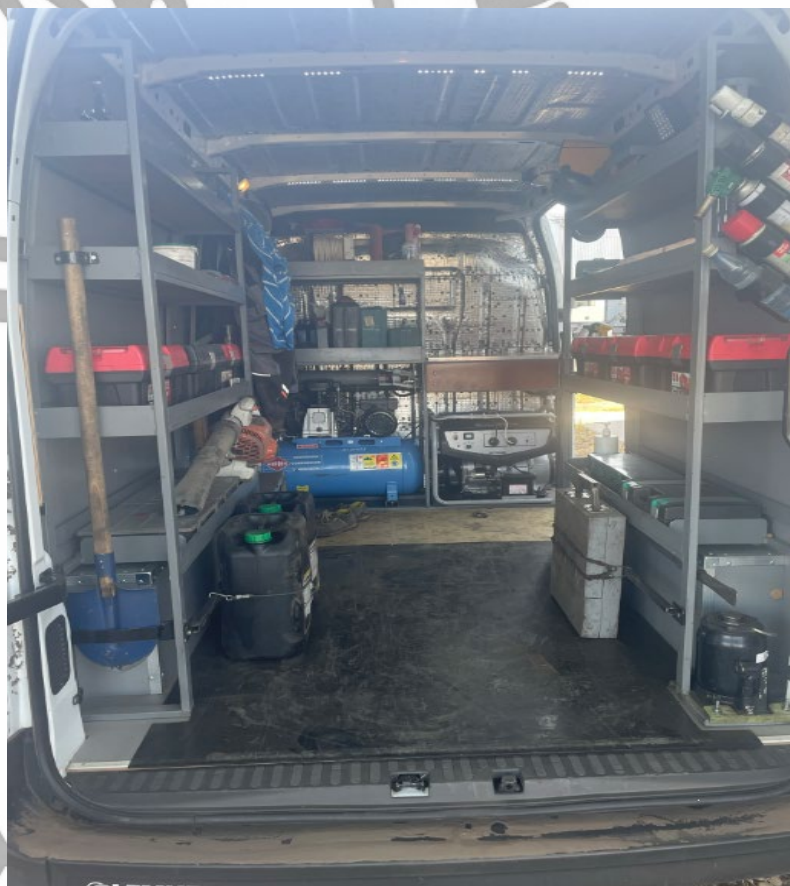
Рисунок 2.1 – Загальний вид вантажної кабіни для мобільної майстерні
