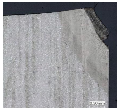
Рисунок 2.14 - Наявність незаповненого зварного шва
