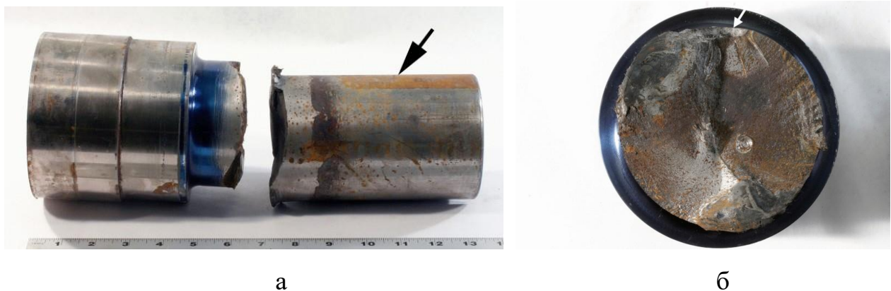
Рисунок 2.12 - Місце розриву валу двигуна (а) та розлому валу (б)
