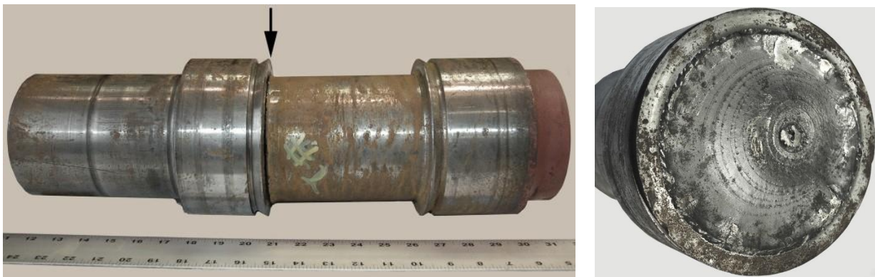
Рисунок 2.10 - Зламаний вал (а) та одна з поверхонь розлому (б)
