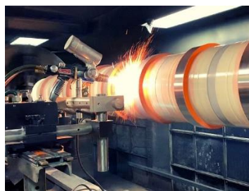
Рисунок 2.2 – Термічне напилювання валів [5]
