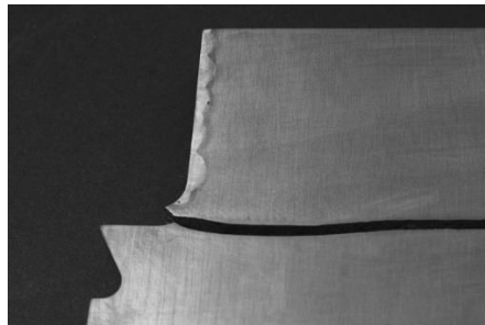
Рисунок 2.11 - Втомне розтріскування при гарячому розтріскуванні в загартованій ЗТВ
