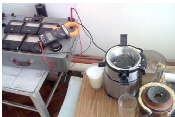
Рисунок 3.5 – Загальний вигляд експериментальної установки для подрібнення замоченого соєвого зерна з змінними абразивними дисками
