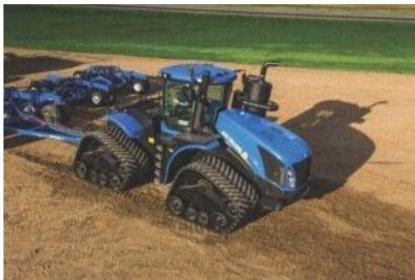
Рисунок 1.8 – Квадроцикл New Holland зазвичай використовує 13-літровий двигун Cursor потужністю 400–600 к.с. Фото надано CNH Reman
