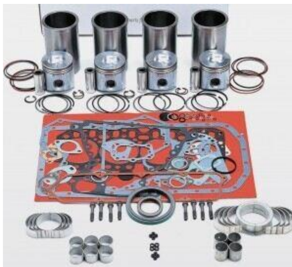
Рисунок 1.6 – Деталі, знос яких призводить до капітального ремонту двигуна. Фото надано Maxiforce
