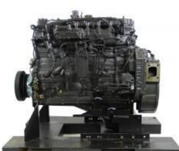
Рисунок 1.5 – Шести-циліндровий (6,72 л) двигун фірми Case/New Holland. Фото надано CNH Reman
