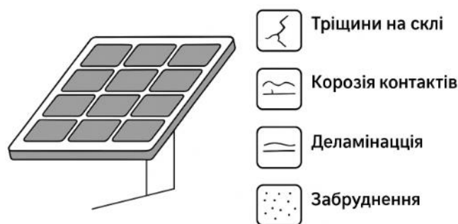
Рисунок 1.3 – Дефекти при візуальних інспекціях
