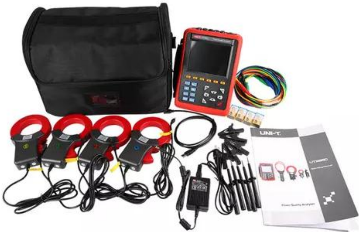
Рис. 2.1. Аналізатор якості електроенергії UNI-T UT285C
