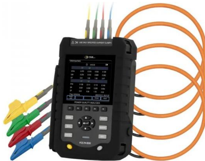
Рис. 3.1 – Портативний аналізатор якості електроенергії з функцією захисту типу PCE-PA 8500
