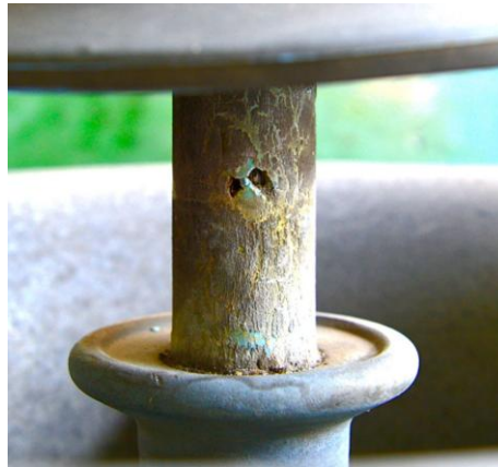
Рис. 1.5 – Забруднення поверхні ізолятора солями та пилом
