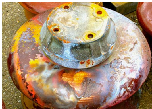
Рис. 1.3 – Перекриття фарфорового ізолятора під дією атмосферної перенапруги
