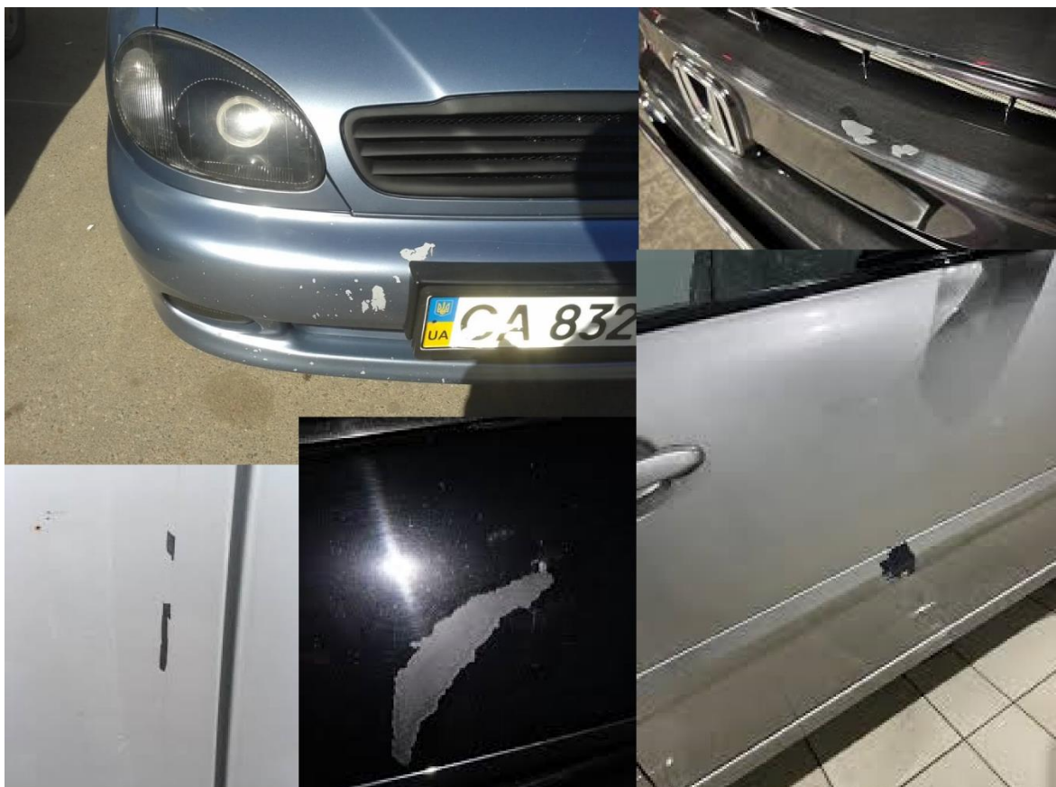
Рисунок 3.2. Пошкоджене лакофарбове покриття авто мийкою високого тиску
