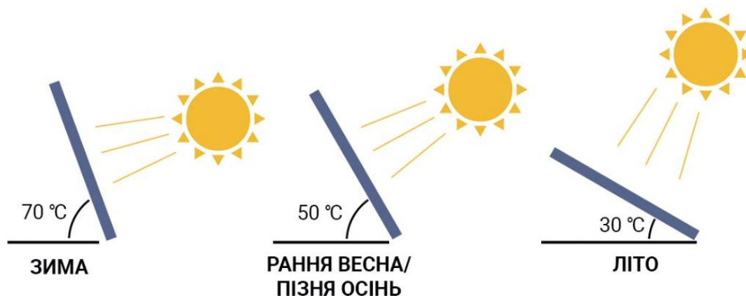
Рисунок 1.2 – Вибір оптимального кута нахилу сонячних панелей
