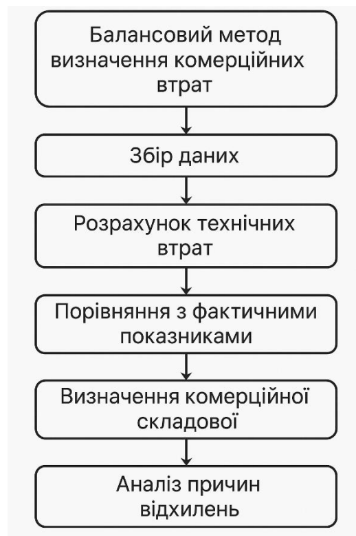
Рис. 1.4. Структурна схема балансового методу визначення комерційних втрат електроенергії
