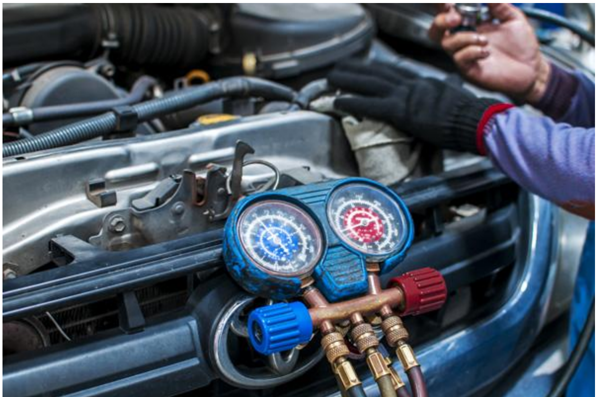
Рисунок 3.1 – Процес обслуговування автокондиціонера транспортного засобу
