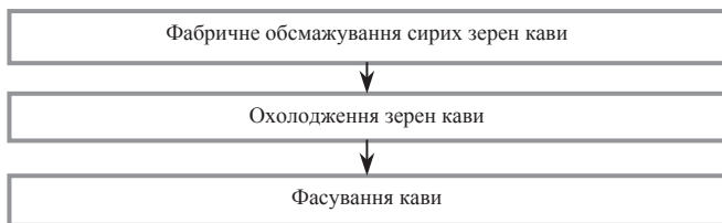
Рис. 4.3. Узагальнена схема виробництва кави
