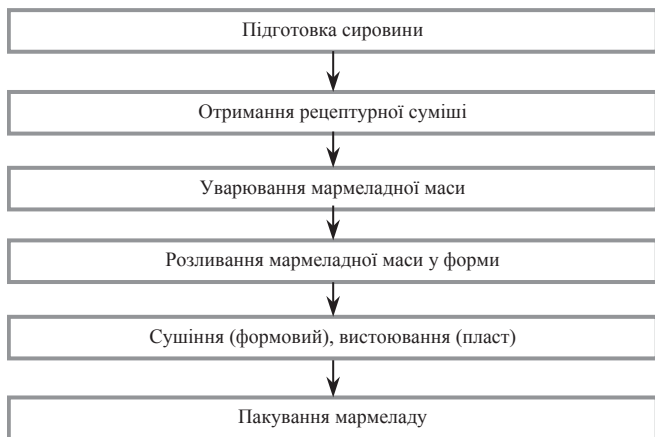
Рис. 3.3. Узагальнена схема виробництва фруктового-ягідного мармеладу
