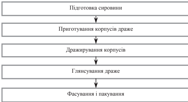
Рис. 3.11. Узагальнена схема виготовлення драже
