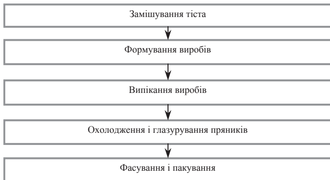
Рис. 3.14. Узагальнена схема виробництва пряників
