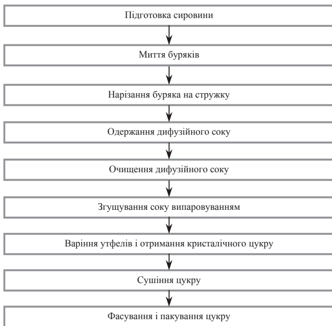
Рис. 3.2. Узагальнена схема виробництва цукру-піску
