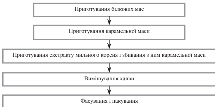
Рис. 3.12. Узагальнена схема виробництва халви
