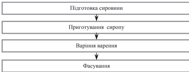
Рис. 3.6. Узагальнена схема виробництва варення
