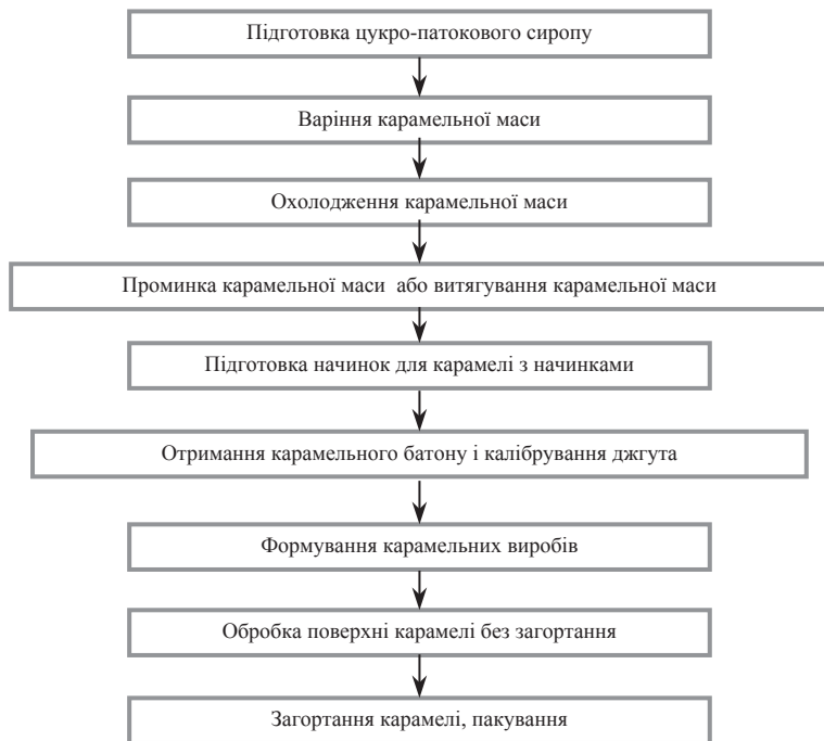
Рис. 3.7. Узагальнена схема виробництва карамелі
