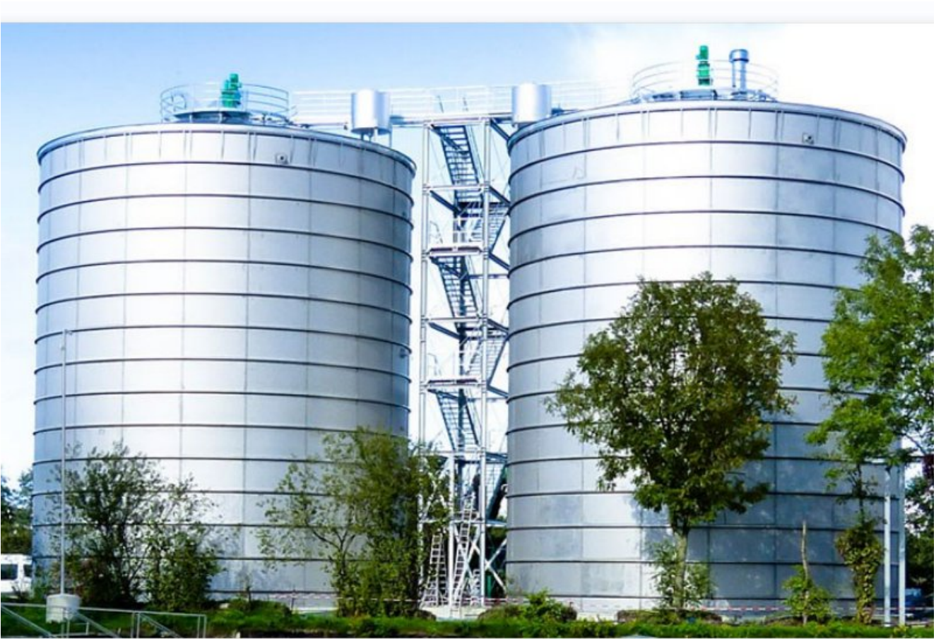
Рисунок 1.2 – Реактор типу CSTR неперервної дії з мішалкою
