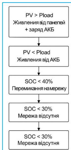
Рисунок 2.2 – Алгоритм автоматизованої роботи системи електропостачання
