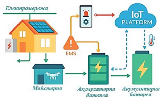
Рисунок 2.3 Схема взаємодії IoT-платформи з елементами системи енергопостачання
