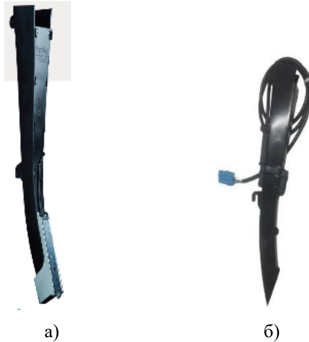
Рисунок 2.3 - Трубка (насіenneва): а) Precision Planting - ультразвуковий датчик WaveVision; б) Kinze- оптичний датчик
