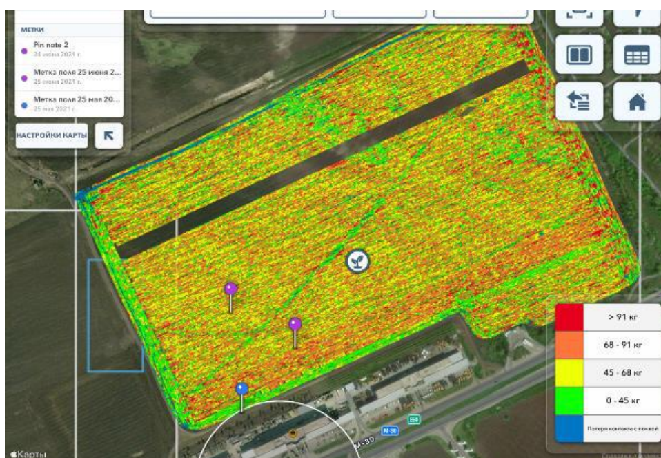
Рисунок 3.1 - Карта розподілу прикладеного притискного зусилля під час посіву на дослідному полі
