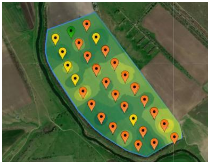
Рисунок 1.9 - Вимірювання твердості ґрунту на одному з полів фермерського господарства на глибині висіву показали її нерівномірність (дані отримано за допомогою цифрового пенетрометра SkokAgro S600 ).
