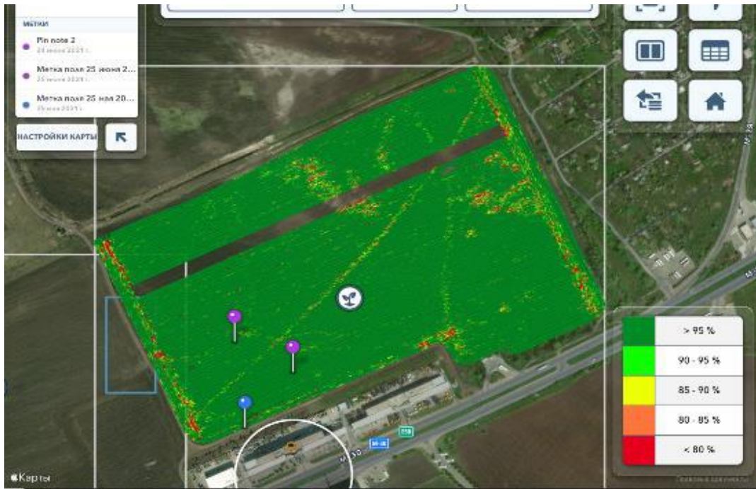
Рисунок 3.7 - Карта вібрацій посівних секцій
