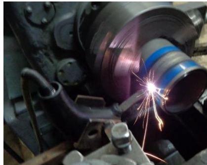
Рисунок 2.1 - Відновлення зношеної ділянки валу при механізованій обробці методом ЕІЛ
