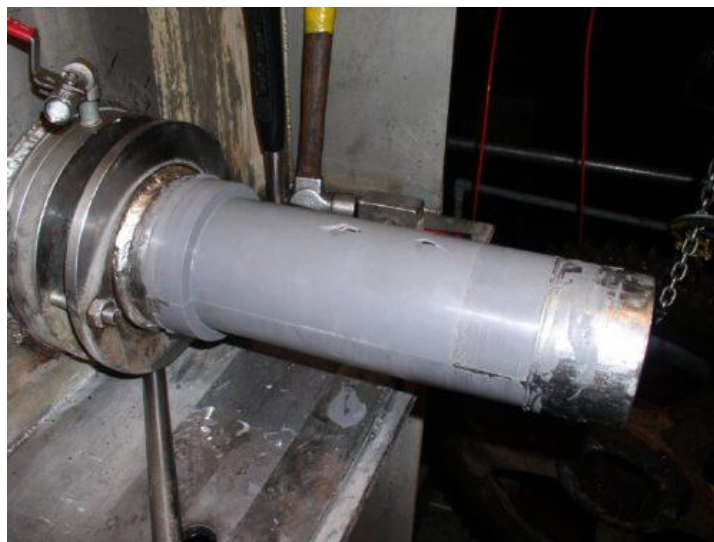
Рисунок 1.6 – Покриття, типу Belzona, нанесене на підшипникову шийку валу
