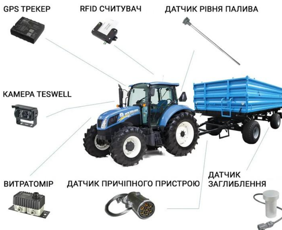
Рисунок 2.1 - Основні компоненти системи дистанційної діагностики трактора
