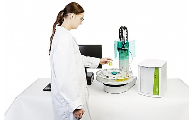
Рисунок 4.4 – Зовнішній вигляд «електронного язика» від французької компанії Alpha MOS
