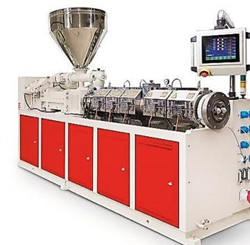
**Рисунок 1.2** – Двошнековий екструдер
