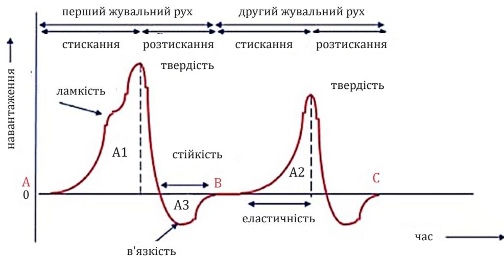
Рисунок 4.9 – Крива текстурометра в координатах «навантаження – час»
