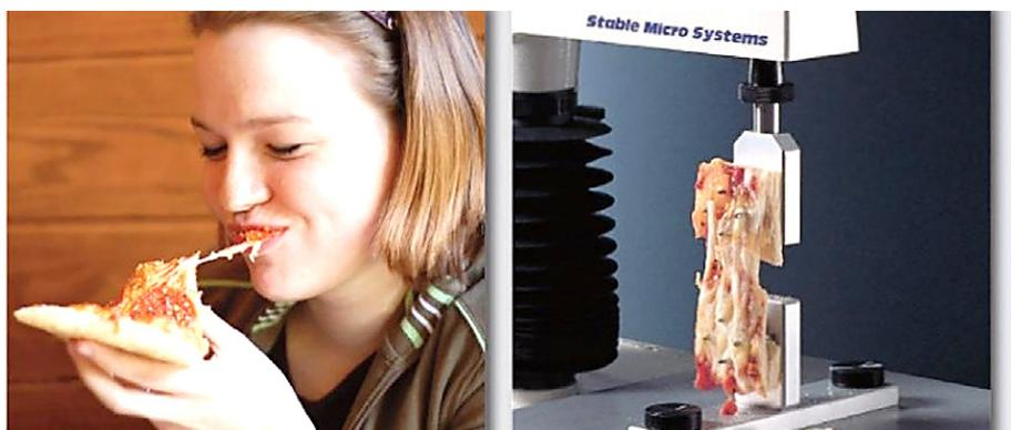
**Рисунок 4.6** – Візуалізація процесу відкушування та відповідний процес дослідження з використанням текстурометра
