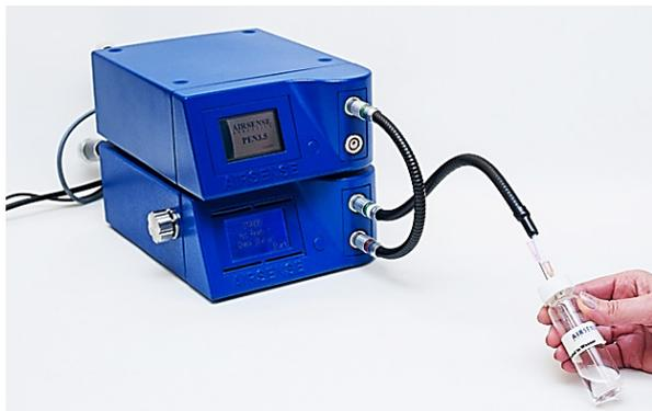
**Рисунок 4.1** – Зовнішній вигляд портативного «електронного носа» від німецької компанії AIRSENSE Analytics
