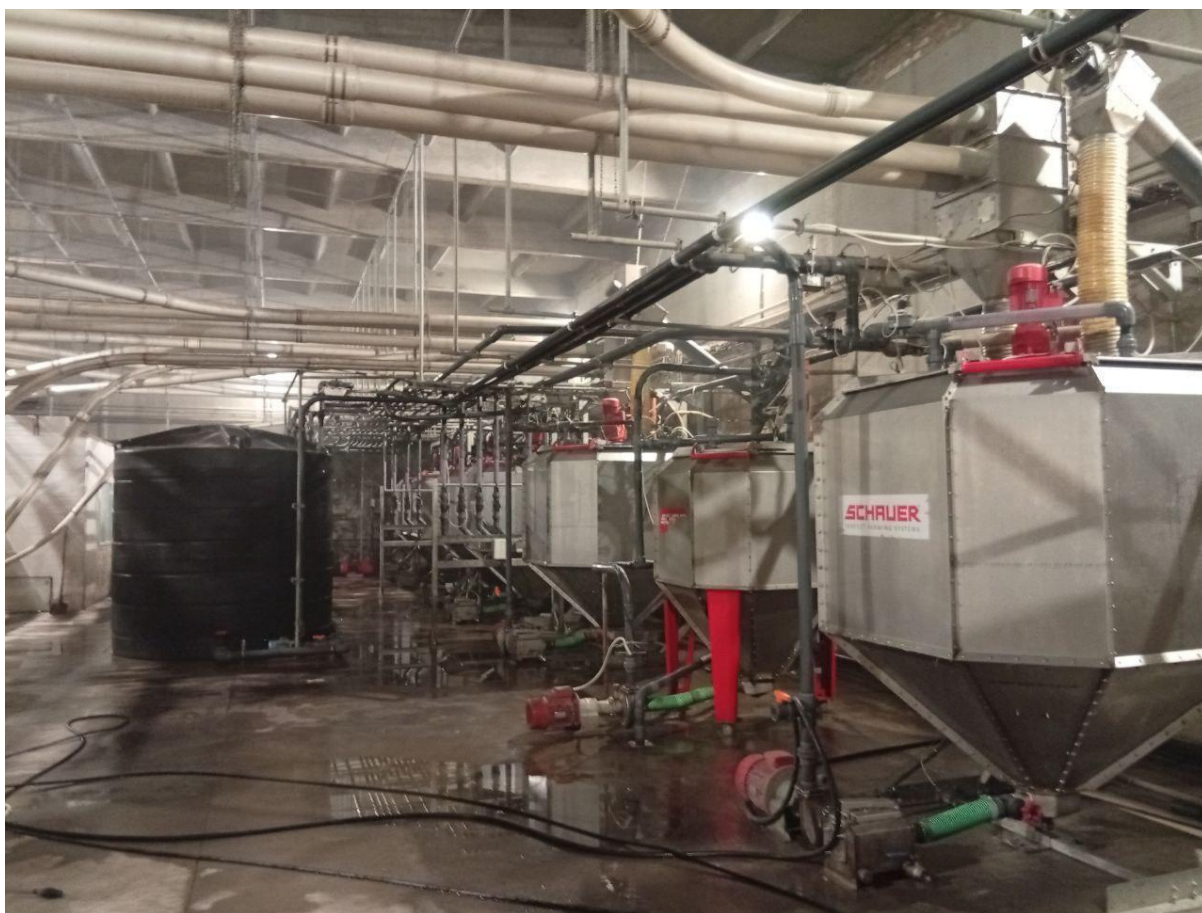
Рис. 2.14. Кормова кухня Megamix австрійської фірми Schauer для годівлі і обліку кормів під час відгодівлі у другому досліді третьої серії досліджень
