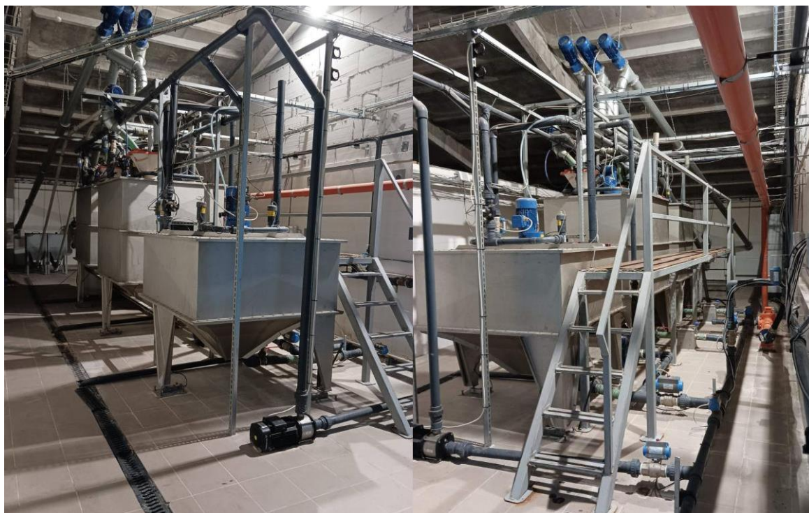
Рис 2.12 Кормокухня Hydro Mix Pro (Big Dutchman) для приготування рідкого замітника молока і рідких кормосумішей для поросят піддослідних груп у першому досліді третьої серії досліджень
