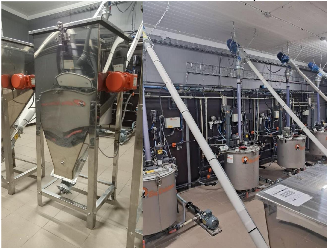
Рис. 2.9. Кормокухня Cullina Mix Pro для приготування рідкого заміника молока для підсисних поросят у третьому досліді другої серії досліджень
