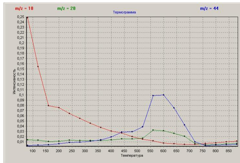
Рис. 3.8. Термограми виділення зі зразків бетону у приміщенні пташника з підстилкою на солоні: H 2 O (m/z 18), CO (m/z 28), CO 2 (m/z 44)
