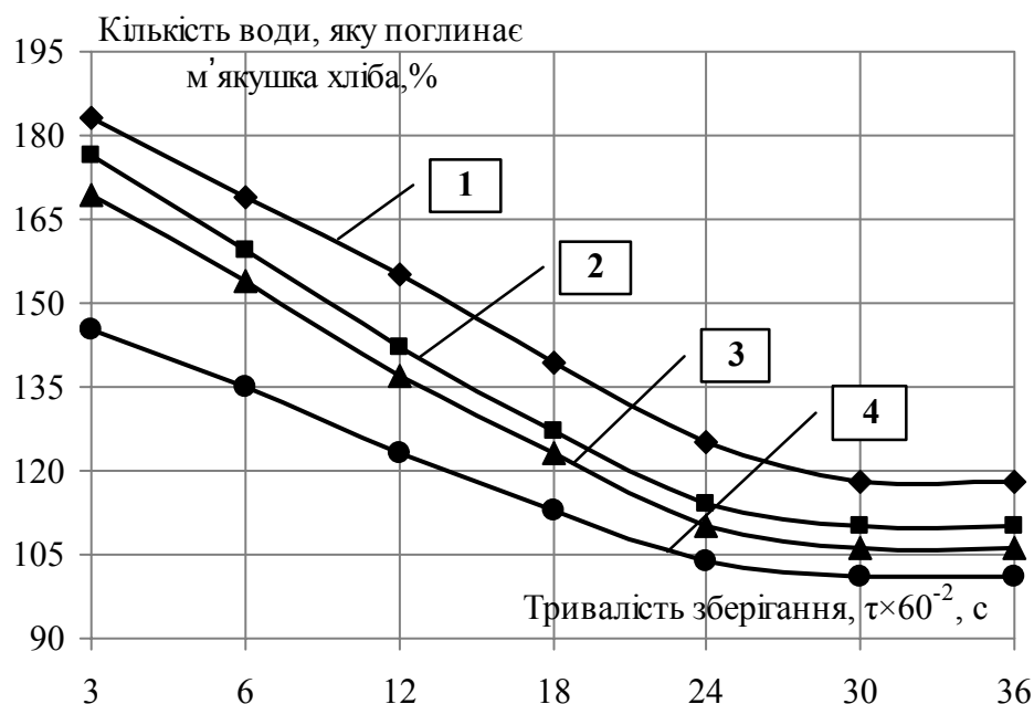
Рисунок 4.7 – Зміна кількості води, яку поглинає м'якушка хліба, в процесі зберігання при додаванні олії в кількості, % до маси крохмалю: 1 – 0 (контроль); 2 – 5; 3 – 10; 4 – 15
