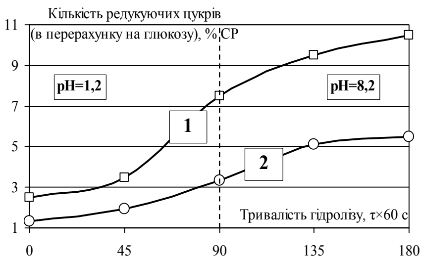
Рисунок 5.8 – Перетравлюваність in vitro вуглеводів хліба: 1 – традиційного з пшеничного борошна (контроль); 2 – безбілкового хліба
