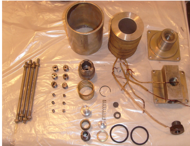
Рис.5. Модулятор тиску зі змінними прохідними перетинами (зразок для дослідження): а – конструктивна схема, б – модулятор тиску в розібраному стані.
