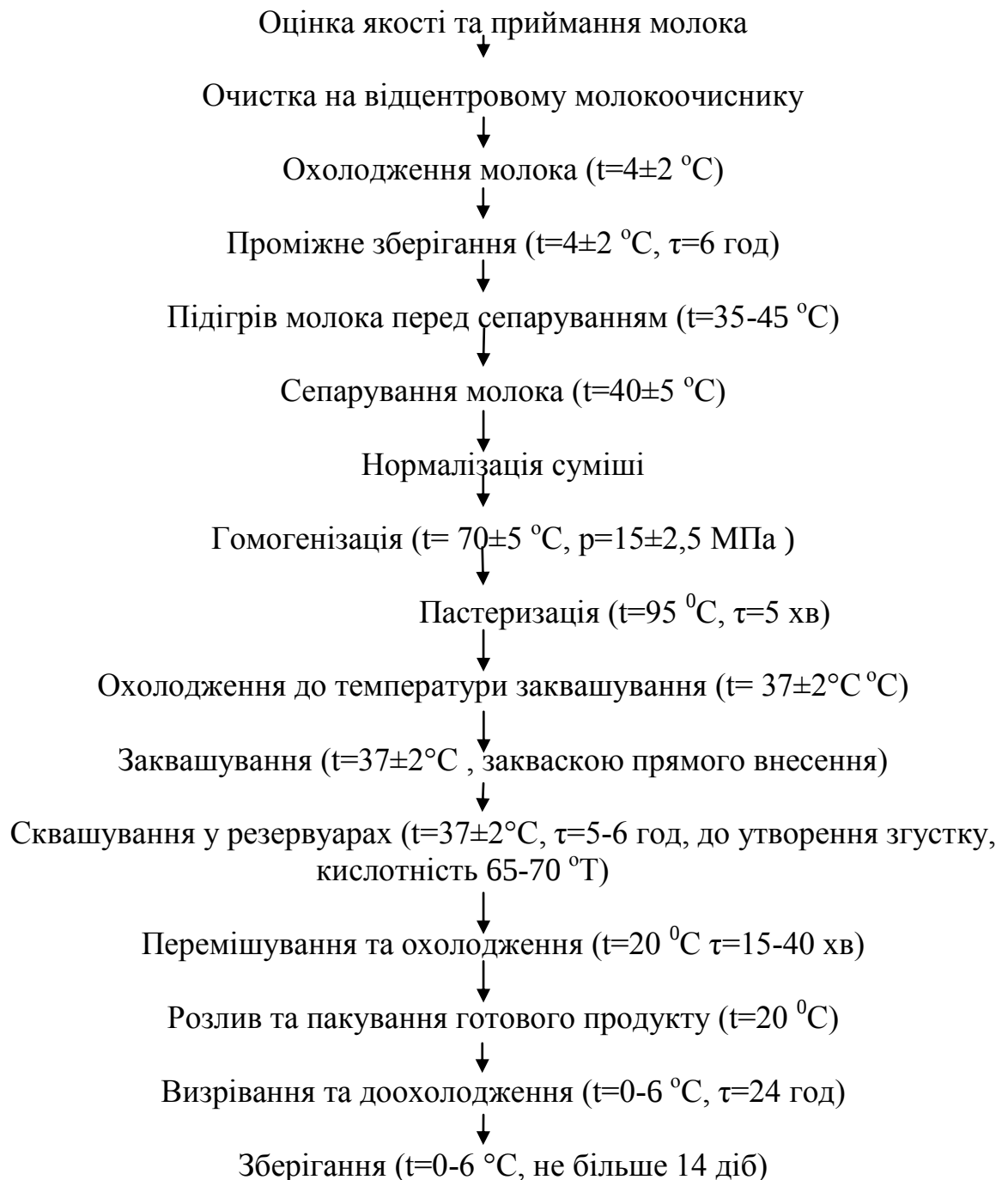
Рисунок 2—Технологічна схема виробництва продукту-аналогу
