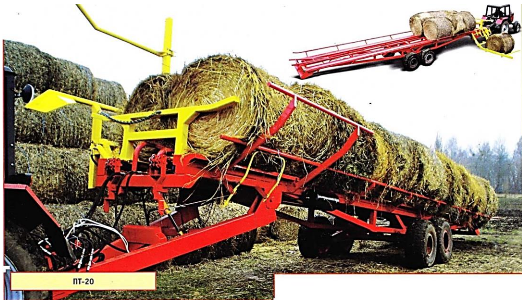
Рис. 1. 14. Причеп-тюковоз самозавантажувальний ПТ-20
