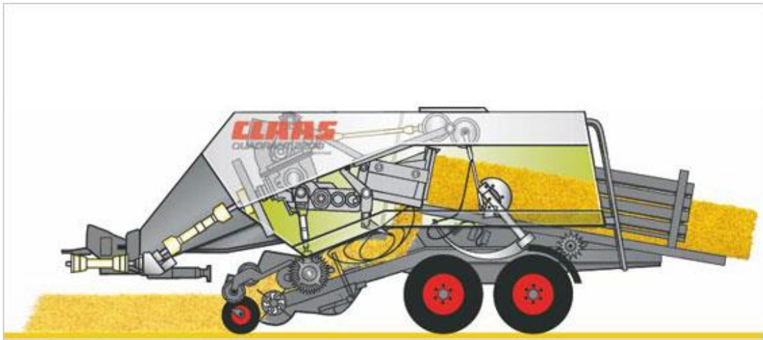
Рис. 1.12. Технологічна схема прес-підбирача Quadrant 2200
