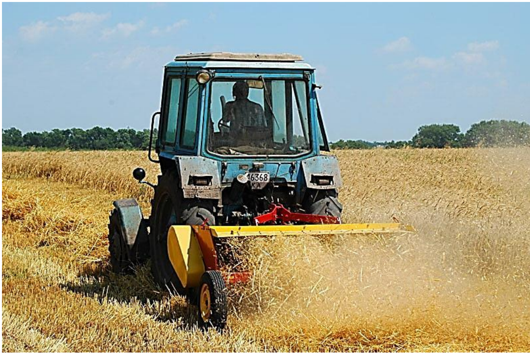
Рис. 1.5. Подрібнювач-мульчувач начіпний ПР-1,2
