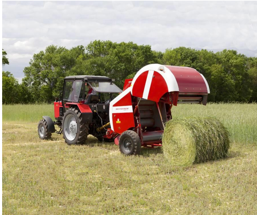
Рис.1.7. Рулонний прес-підбирач російського виробництва ППР-120 Pelikan
