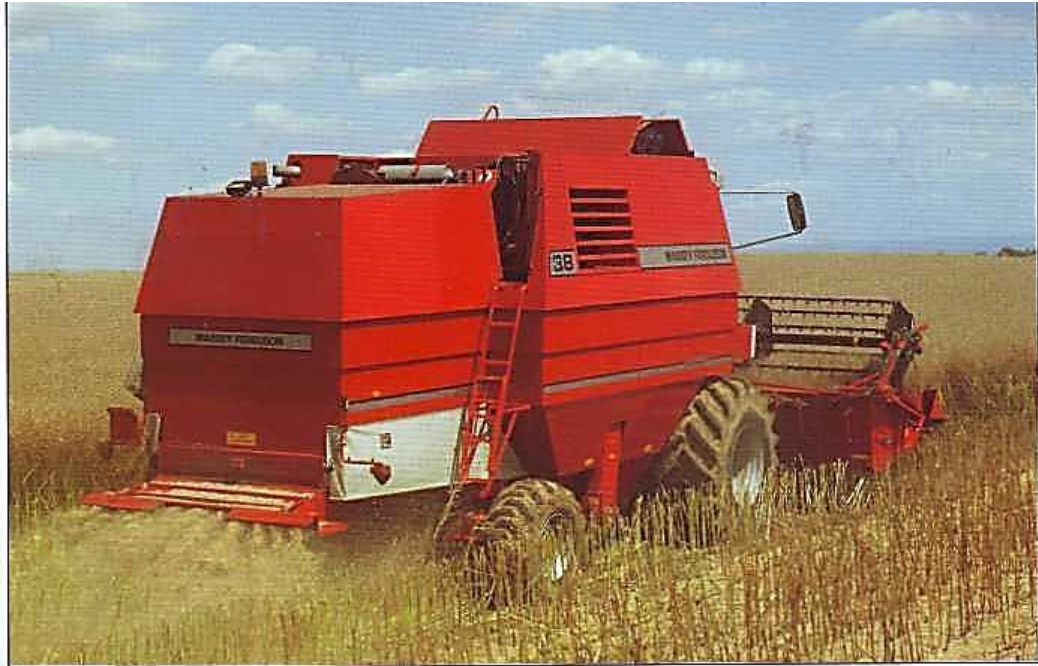
Рис. 1.4.Зернозбиральний комбайн серії 30/40 фірми Массей Фергюсон, обладнаний начїпним подрїбнювачем
