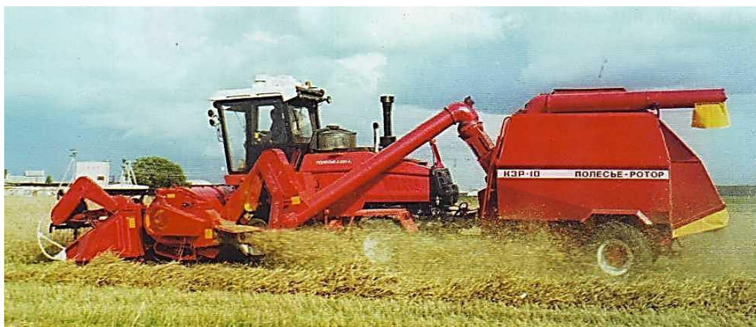
Рис. 1.1.Блоково-модульний зернозбиральний комплекс КЗР-10 «Полесьє-Ротор»
