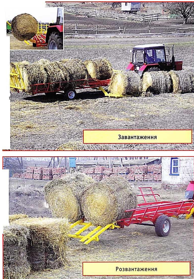
Рис. 1.15. Принцип роботи причіпа-тюковозасаморозвантажувального ПТ-20 для рулонів
