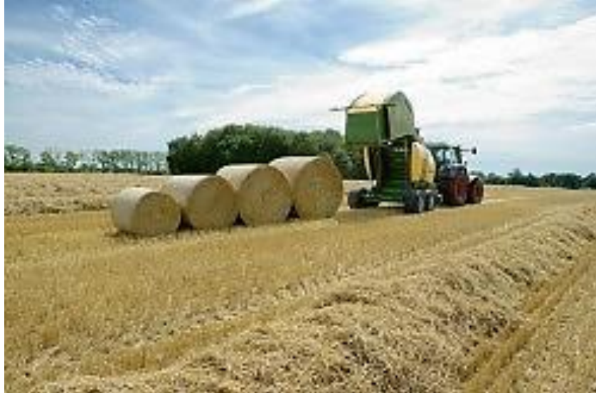
Рис.1.9.Прес-підбирач рулонний фірми KRONE (Німеччина)
