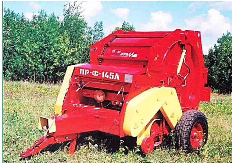
Рис. 1.6. Прес-підбирач рулонний безремісний ПР-Ф-145
