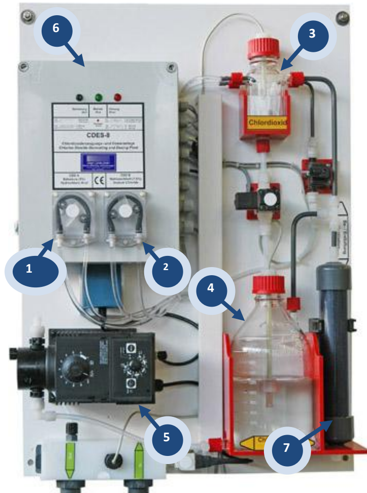
Рис. 1. Установка для отримання діоксиду хлору виробництва компанії JürgenLöhrkeGmbH.
