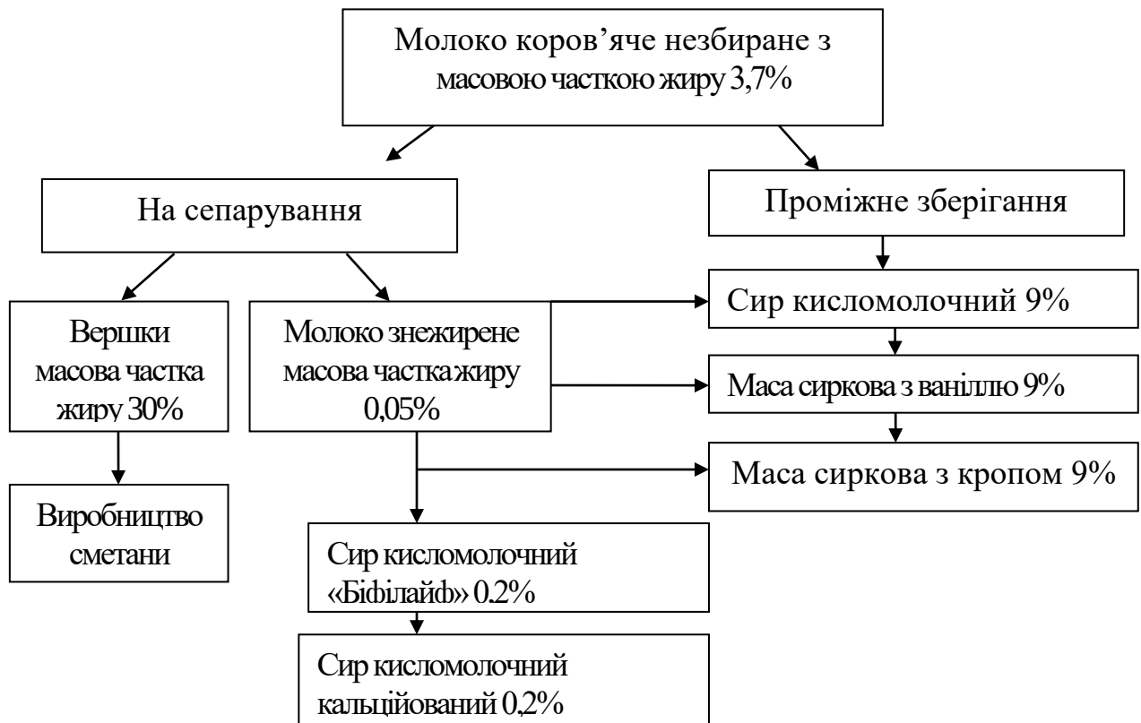
Рис. 3.6 – Схема технологічного напрямку переробки молока в цеху.
