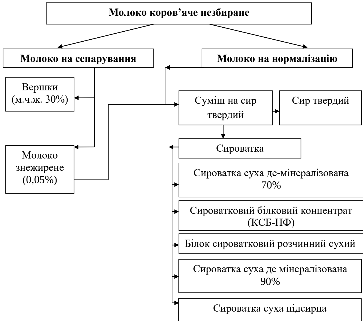
Рис. 3.4.1-Схема направлення переробки сировини
