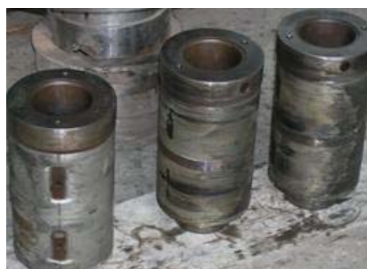
Рис. 1. Разрушение баббитового слоя опорных пальцев зубчатых колес.
