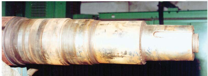
Рис. 3. Вала ротора насоса ЦНС-180 с изношенными поверхностями.
