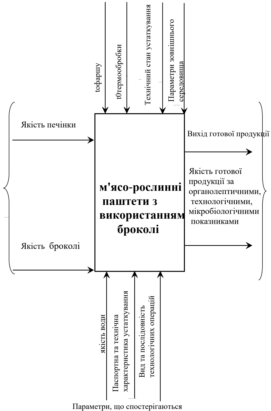
Рисунок 3.1 – Параметрична схема виробництва м'ясо-рослинних паштетів з використанням броколі
