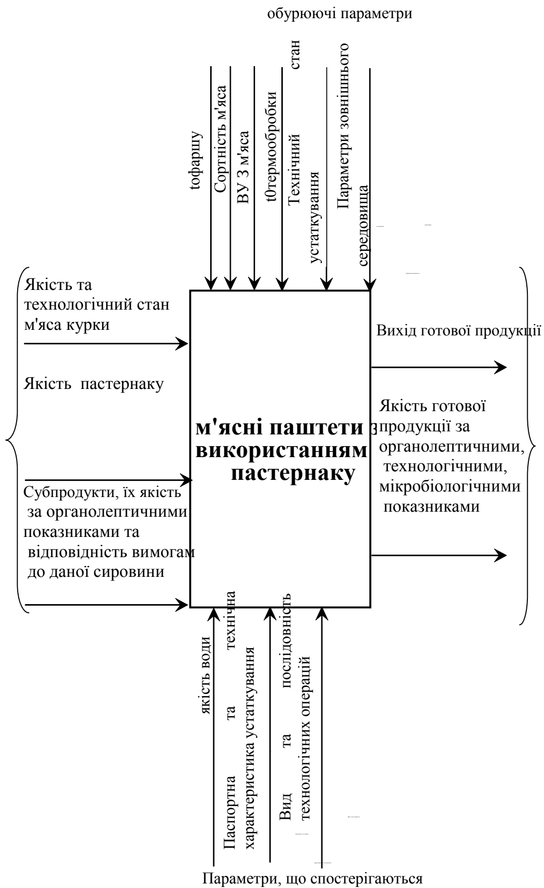
Рисунок 4 – Параметрична схема виробництва м'ясних паштетів з використанням пастеризованого м'яса
