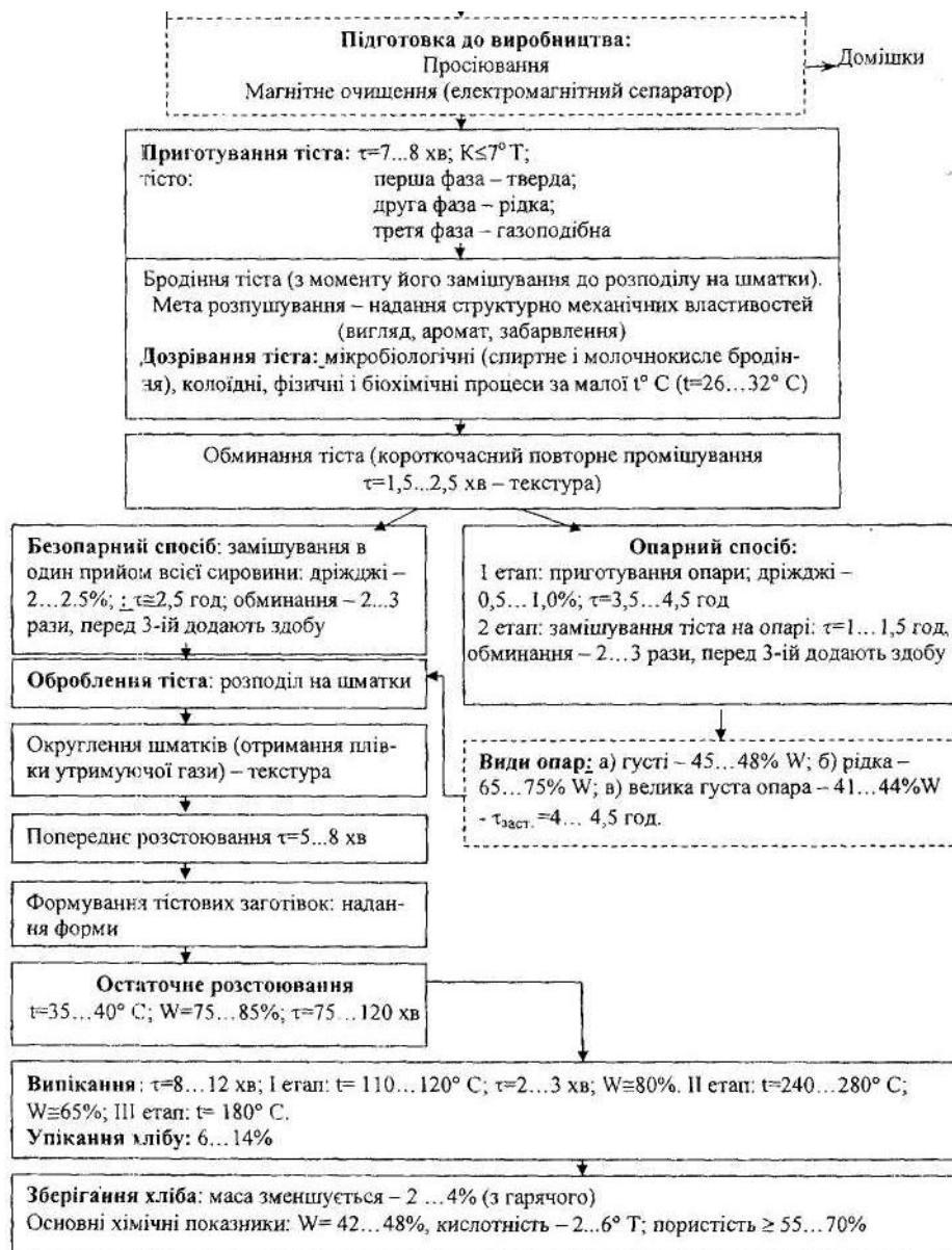
Рис. 1. Векторна технологічна схема процесу виробництва хліб «Житній простий»
