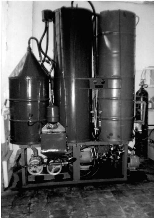
Рис. 3. Установка для відновлення експлуатаційних властивостей відпрацьованих масел.
