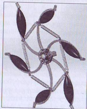
Рис. 2. Макетний зразок рухомого засобу з вбудованим в колісний рушій динамічного накопичувача енергії
