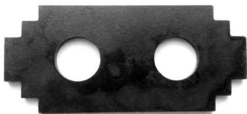
Рисунок 4 - Области зносу молотка дробарки КДУ
