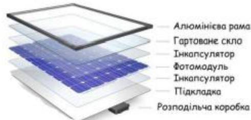
Рис.2. Структура сонячної батареї
