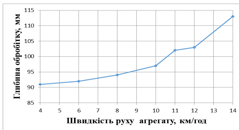
Рис. 2 – Зміна глибини дискування при зміні швидкості руху машинного агрегату у складі ХТЗ 17221 + УДА-3,8
