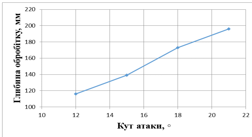
Рис. 4 – Зміна глибини дискування при зміні кута атаки машинного агрегату у складі ХТЗ 17221 + УДА 3,1
