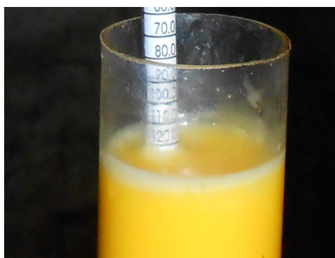
Рис. 3 Вимірювання кількості Ig (г/л) колостриметром
