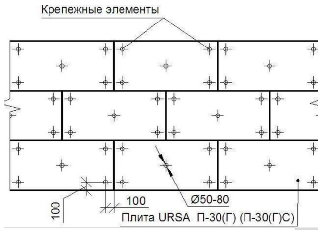
Рис.3.4- Приклади кріплення плит мінероловатних ( одношарове утеплення)
