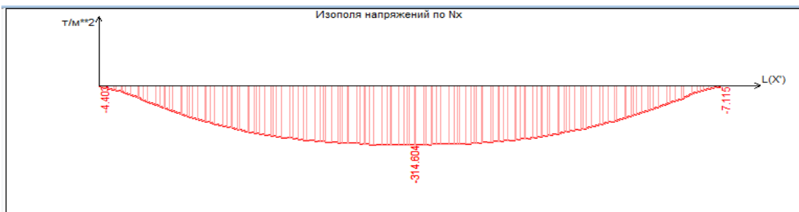
Рисунок 2.5 Головні напруження в обшивці покриття
