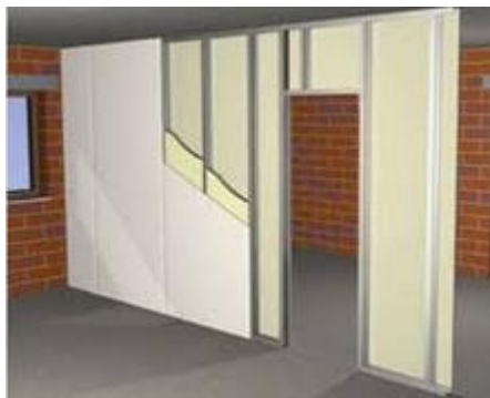
Рис. 2.15 Влаштування перегородок на збірній багатопорожнистій плиті Отже, змодельюємо навантаження від перегородки, що влаштована на другій від лівого краю ячейки плиті. Перегородка розташована вздовж плити (рис.2.17) як рівномірно розподілене погонне навантаження.
