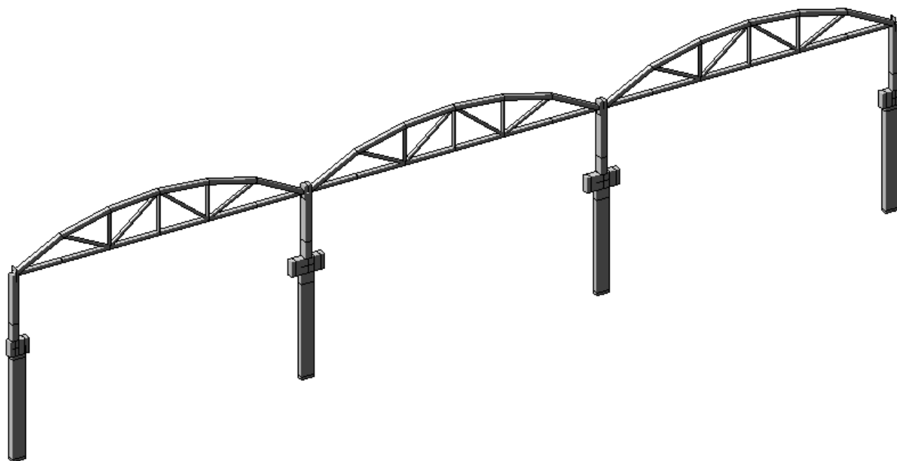
Рис. 2.1. 3-и вимірна модель поперечника проектуємої будівлі
